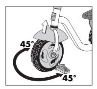
Rear steering system locked/unlocked Direction arrière bloquée/libre
